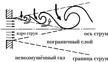
Рис. 132. Схема образования турбулентно-пограничного слоя в составе свободной затопленной струи. Крупные белые стрелки – вихри газа струи. Крупные чёрные стрелки – вихри подсосываемого (эжектируемого) газа.
