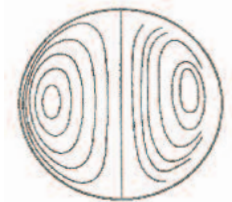
Рис.124. Сравнение теоретических /слева/ и наблюдаемых /справа/ линий тока в сферической капле глицерина, падающей в касторовом масле [79].
