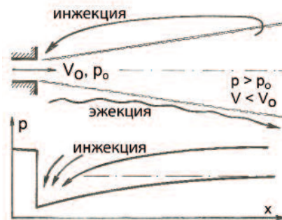
Рис. 146. При истечении затопленной струи в пространство, заполненное жидкостью, возникают инерциальные течения за счет подсоса внешней среды в область пониженного давления /инжекция/ и вязкостные течения за счет увлечения неподвижной внешней среды движущейся струей /эжекция/.
