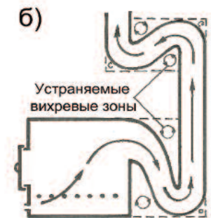
Рис.144. Пример металлической печи с дымооборотами [94]: а - места возможных завихрений, б - сглаживание поворотов устраняет наличие вихревых зон.
