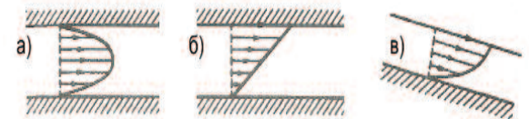
Рис. 128. Установившиеся равномерные движения вязкой жидкости: а - течение в зазоре /или трубе/, б - сдвиг верхней плоскости, в - на наклонной плоскости в поле тяготения.
