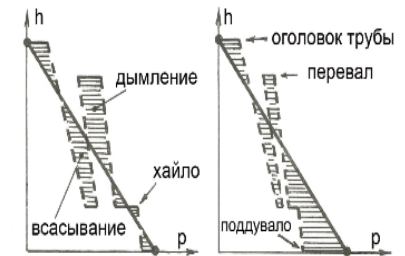
Рис.223. Эпюры статического давления: а - для традиционной схемы рис.222-а, б - для условно оптимизированной схемы рис.222-б.
