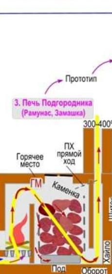
"Обращёнка" с оборотом, дым.газы в дымоходе не горячие. Длиннее путь огня до заряда (чем на рис. 1-2) - это полезно для дожига пиролизных газов.
