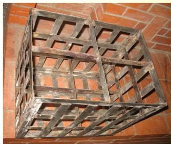
Рис.8. Бункер для каменки по-белому – камни калим через стенку корыта (слева), сетка для камней по-чёрному, помещаемая в огонь печи (справа).
