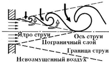
Рис. 53. Схема образования турбулентного пограничного слоя между струей пара и неподвижным воздухом. Крупные белые стрелки – вихри пара. Крупные чёрные стрелки – вихри воздуха, подсосываемого в струю пара.
