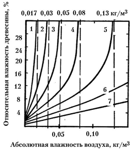
Рис. 57. Зависимость равновесной относительной влажности древесины от абсолютной влажности воздуха при различных температурах: 1 — 20°C, 2 — 30°C, 3 — 40°C, 4 — 50°C, 5 — 60°C, 6 — 70°C, 7 — 80°C. Абсолютно сухая древесина может быть получена в абсолютно сухом воздухе только при 100°C и выше.
