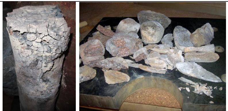
*Рис. 2.21. При поддаче воды на раскалённые чугун и камни, они трескаются, крошаются и пылятся.*
