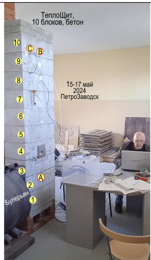
Рис. 1.7. ТЩ КАМИ-Б2 – блоки из жаростойкого талькобетона. Дифференц. манометр, подключён к каналу на выходе из щита.
