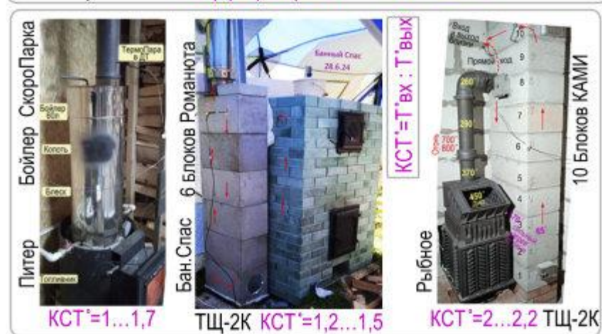
Рис.2.10. Обзор КСТ: Сверху – 3-канал. Снизу – Бойлер и 2-канал. На рис.2,9 вход и выход близки друг к другу и происход подогрев уходящих ДГ входящими. КСТ и КПД снижены. Лучше делать с просветом, как на рис.. 2.13.
