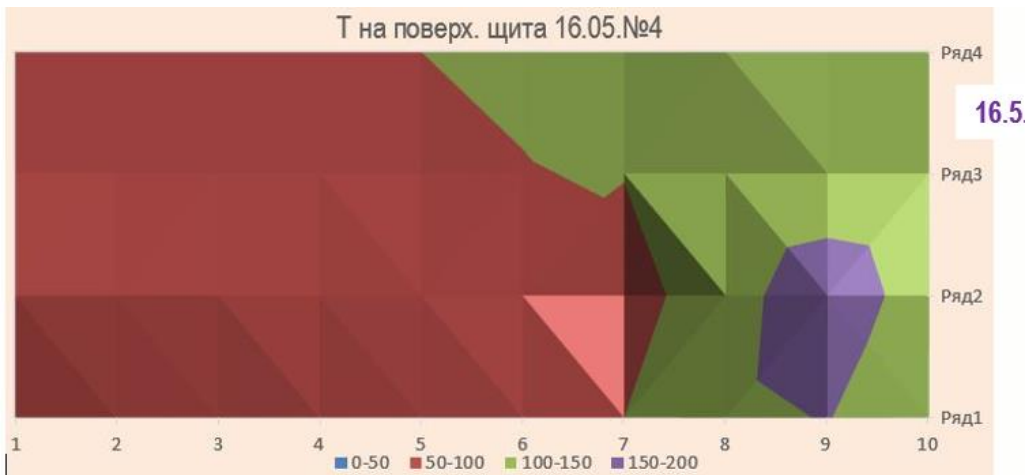
Рис. 1.18.Г (16.5.24) №4 Поле T^\circ на фронтал. (3 ряда) и боковой (ряд.4) поверх. щита (рис.1.18.Б)
