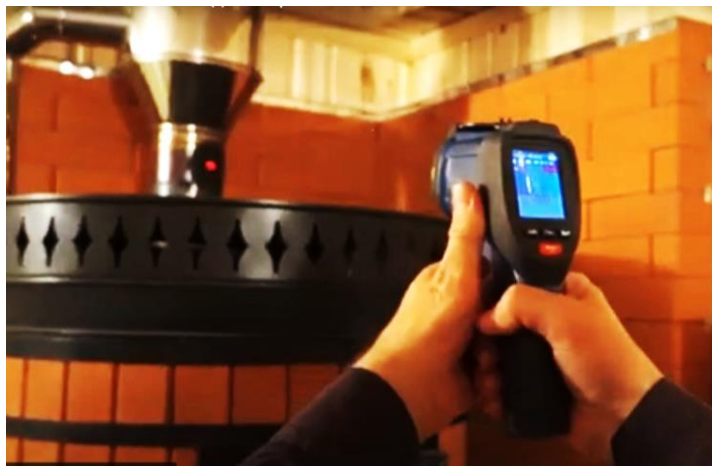
Рис. 3.7. Замер пирометром ДТ снаружи. В поле зрения пирометра предметы с разной T^{\circ} .
