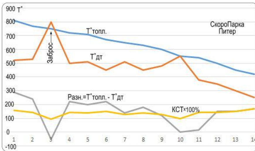
Рис. 2.2. СкороПарка (4.3.24). КСТ= Т°топл./Тдг 1- 1,7 (по рис.2.1) КСТ•100% Разн.=Т°топл.-Тдг в ДТ. (ТЩ КАМИ и Витас → КСТ=2,5-3)
