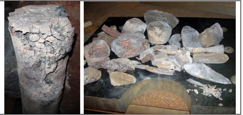
Рис. 2.21. При поддаче воды на раскалённые чугун и камни, они трескаются, крошатся и пылят.
