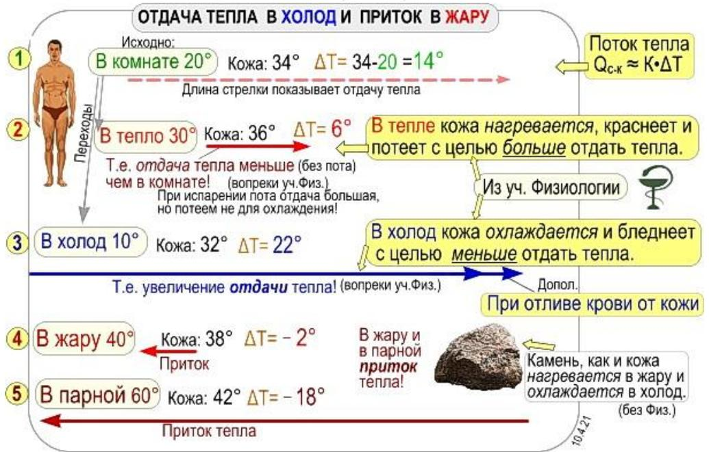
0) Итак, пусть человек без одежды находится в комнате при  $T^\circ$  среды = 20°, и кожа нагрета, к примеру, до 34°C (условно, т.к. в разных точках  $T^\circ$  кожи – разная; поэтому можем следить с помощью пирометра за какой-то характерной точкой – на груди или спине, рис.2.2 и 2.3). При этом  $\Delta T = 34 - 20 = 14^\circ C$  (штриховая длинная стрелка на рис. 2.9)
