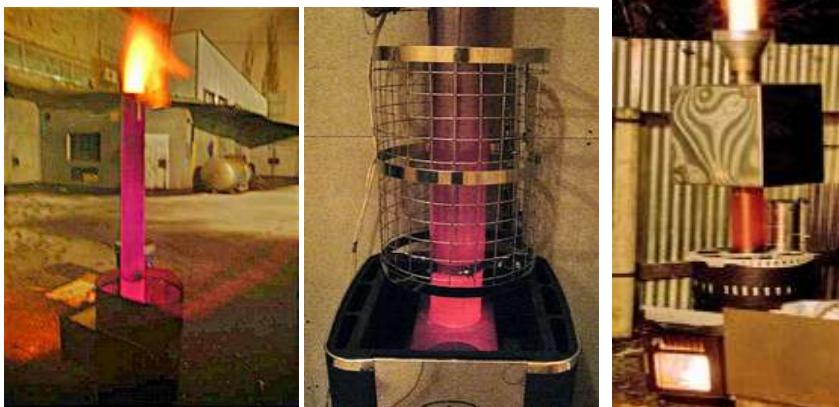
Рис. П-2. Раскалённый дымоход (600-700С) банных металлических Накал-печей
