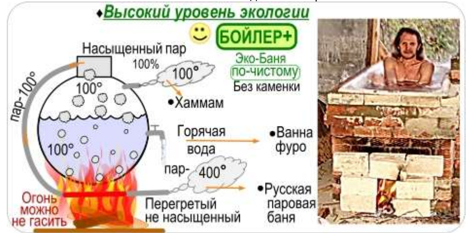
Рис. Э-4. Эффективный Бойлер+ даёт ●горячую воду, ●Пар-100° и ●Пар-400°.
