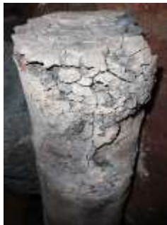
Рис.7. Монолит чугуна разрыхляется в Накал-печи по-серому
