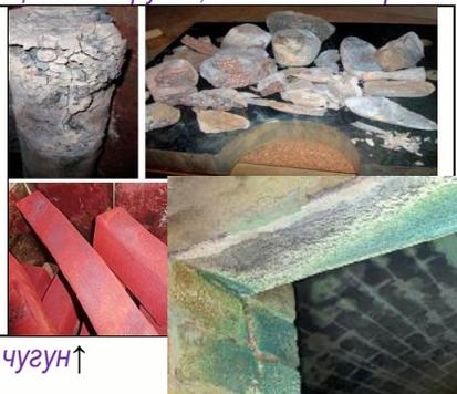
Рис.1.Разрушение серого чугуна; красный хромистый чугун↑ и зелёный токсичный осадок от него. →
