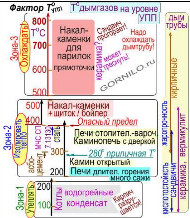
Рис. 2. Выбор дымтрубы в зависимости от T^{\circ} дымгазов в УПП. 400^{\circ} - опасный предел!
