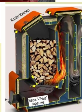
Рис. 16 Мощность огня больше при горении спички (дров) снизу, и тепло не успевает нагреть термометр или стенки печи. КПД низок, риск пожара высок.
