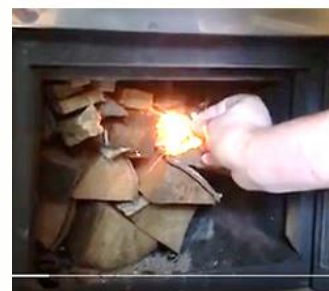
Рис. 15 Поджиг и горение сверху увеличивает КПД сгорания и отбора тепла. Пономарёв А.В. разжигает сверху Для 2-й закладки сдвигает угли к задней стенке. Там и начинается "боковое" горение.
