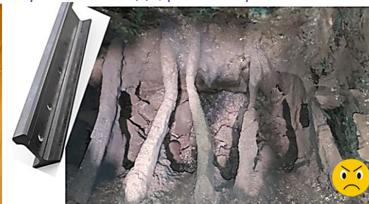
Рис. 5а. Остатки рельсов - обгорели в накал-каменке! Фото Хрусталёва С. (Назарьева) Слева – исходный рельс.
