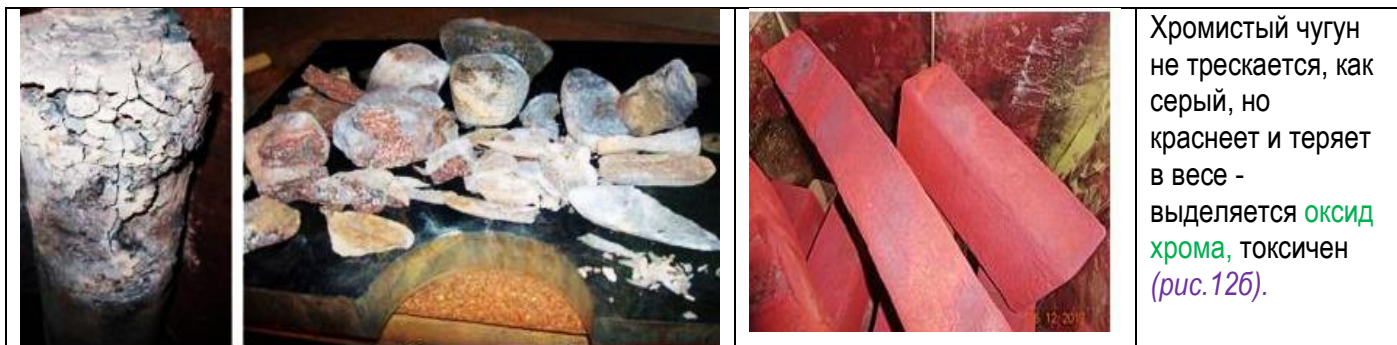
Рис. 1-1. Разрушение в навал-каменке серого чугуна, камней и хромистого чугуна (красный).
