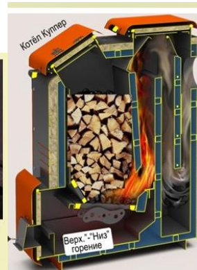
Рис. 7-1,б Пламя вниз, но "от древесины"
