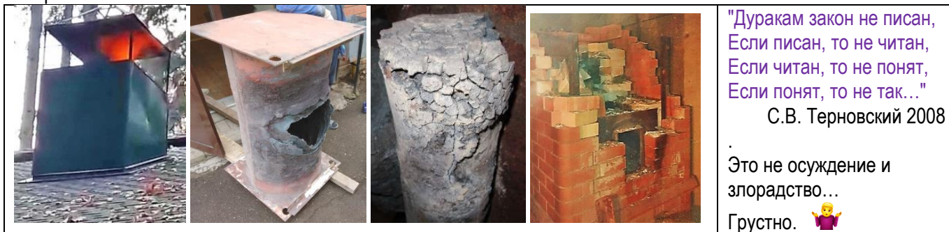
Рис. 3-1. Накал-технология : Огонь над крышей, прогар бункера для камней, разрушение чугуна и печи.
